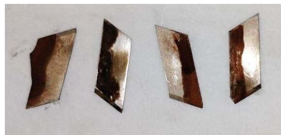
Gambar 5. Korosi pada Logam Besi
