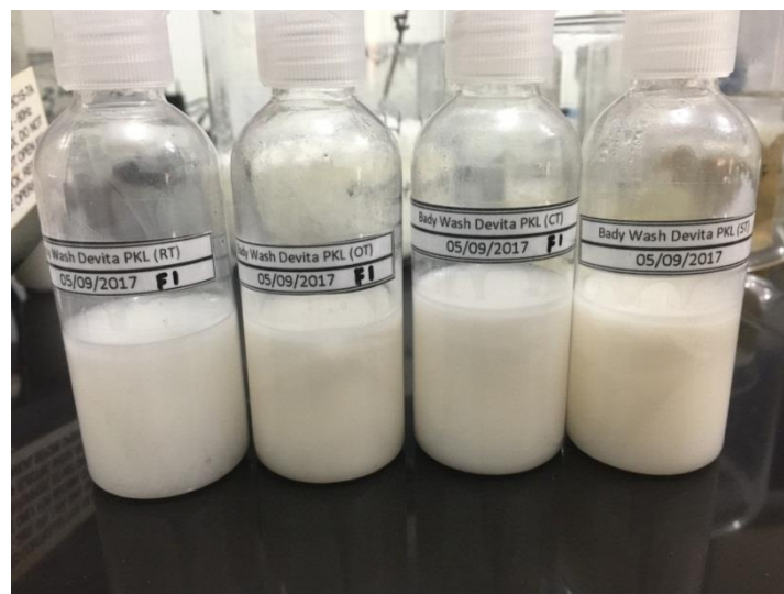
Gambar 1. Sampel sabun mandi cair F1 (Sabun menggunakan surfaktan Sodium Laureth Ether Sulfat (SLES))
