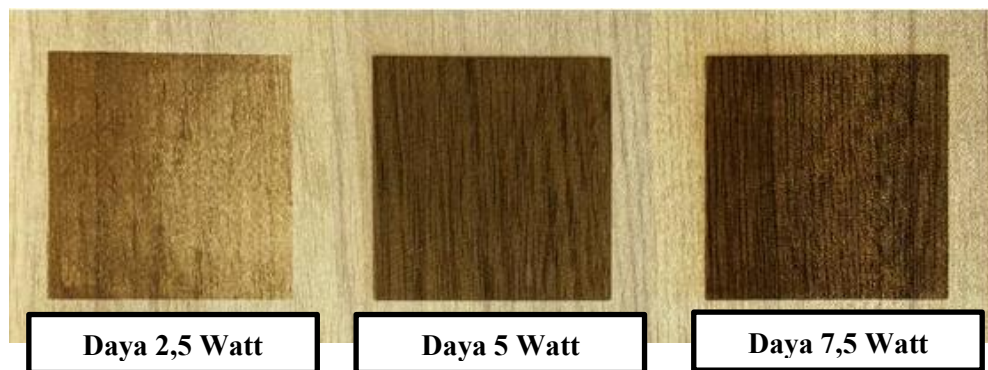
Gambar 3. Hasil visual setelah dilakukan pengukiran laser CO 2 pada kayu cempaka dengan berbagai daya laser.
